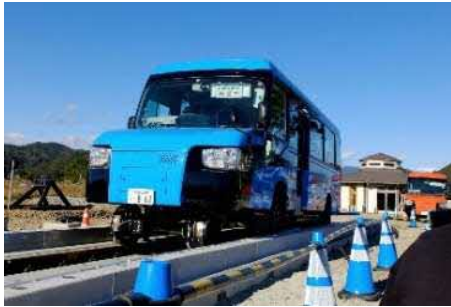
DMV ：線路と道路の双方を走行できる世界初の公共交通
